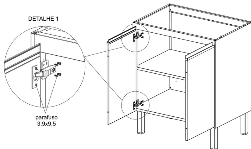
Primeiramente iremos montar as portas. Encaixe as dobradiças pelo caneco nos furos existentes na parte interior das portas, finalize a sua fixação utilizando 2 parafusos 3,9x9,5mm em cada caneco. Feito isso com as quatro dobradiças, duas em cada porta, você irá fixar essa montagem no corpo do gabinete. Nas laterais direita e esquerda existe uma marcação de furos onde você irá fixar o calço da dobradiça como mostra o detalhe 1. Utilize quatro parafusos 3,9x9,5 para fixar cada dobradiça.
