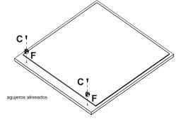
Encaje la estante de cristal en los soportes. Con un destornillador gire el tornillo de abajo sólo lo suficiente para fijar el estante.
